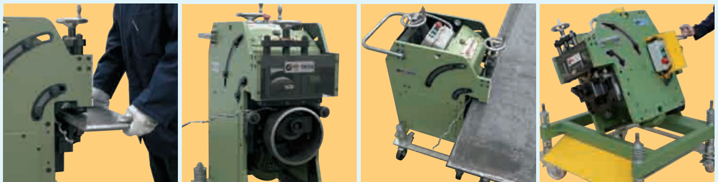
Chaflanado de piezas pequeñas multiformes. Beveling multi-form little parts. Chanfreinage de petites pieces multiformes.
